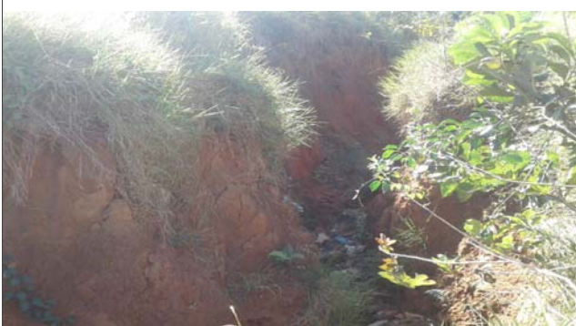
Foto: 1653659111911.jpg ID: 14 Visão geral do setor, Detalhe para processo de erosão, Detalhe para processo de ravinamento, Depósito de escorregamento pretérito, Presença de cicatriz de escorregamento pretérito, Evidência de movimentação no terreno, Formação de processo erosivo
